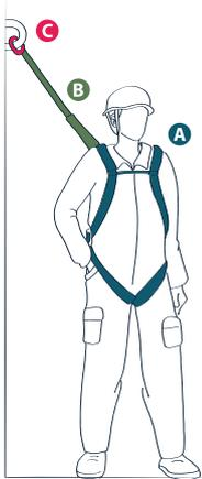
Un sistema individual de detención de caídas consta de al menos 3 elementos
